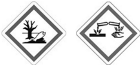
Abb. 20 Gefahrenhinweise für Ammoniak
