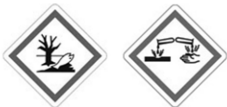
Abb. 21 Gefahrenhinweise für Ammoniak
